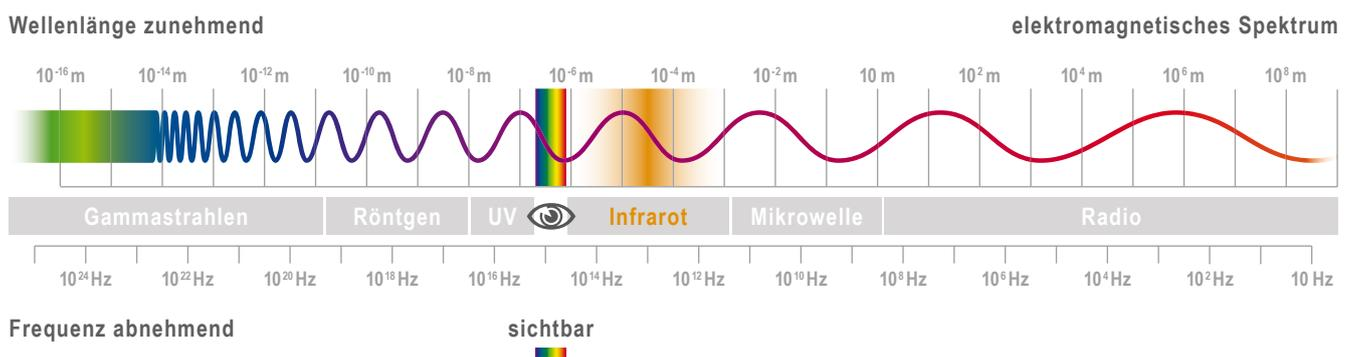
Die Infrarotstrahlung ist Teil des elektromagnetischen Spektrums. Zu ihr zählen elektromagnetische Wellen mit Wellenlängen zwischen etwa einem und einem Tausendstel Millimeter. Auch wenn die Strahlen außerhalb des sichtbaren Spektrums liegen, nehmen die Nerven in unserer Haut sie als Wärme wahr. Infrarotstrahlung ist allerdings nicht mit der berüchtigten, bedenklichen UV-Strahlung zu verwechseln.
